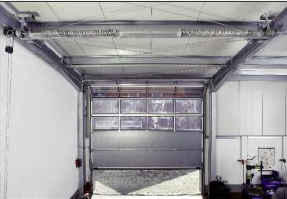
Sectionaltor SLW, Niedrigsturz-Beschlag mit hintenliegender Federwelle, ab 270 mm Sturzbedarf, mit sehr geringem seitlichem Platzbedarf.
