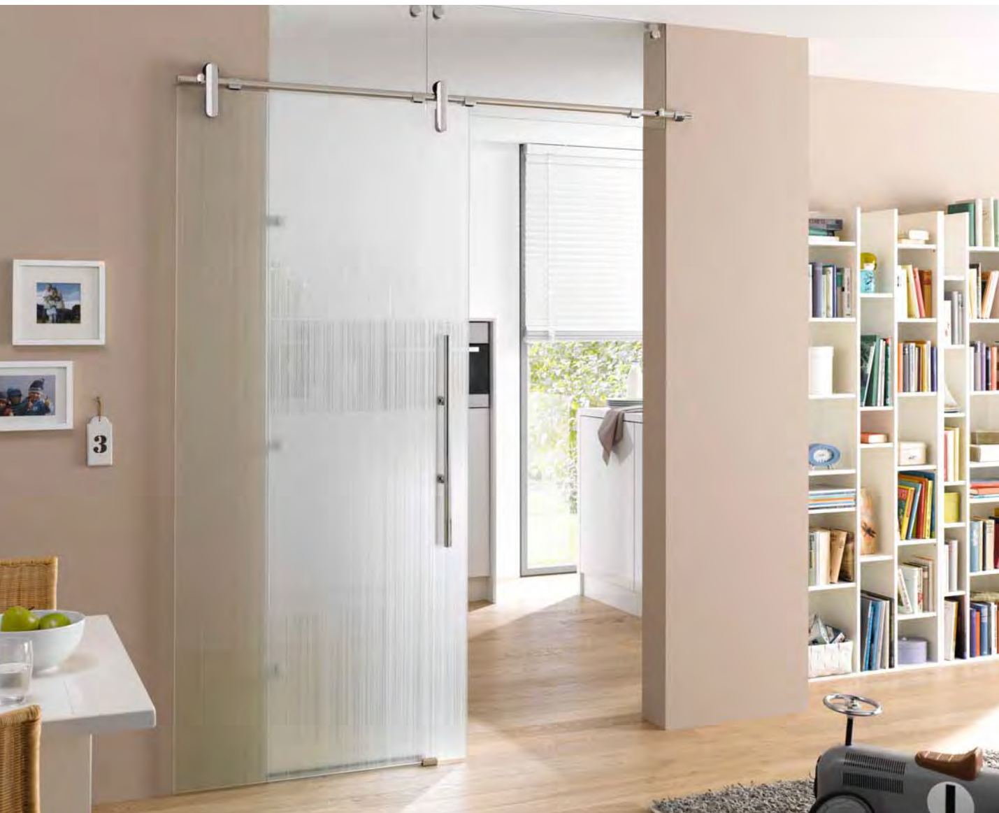
Glasschiebeanlage: Typ 1 | Schiebesystem: Tiro, Edelstahl Chrom Glanz poliert, Seitenteil und Oberlicht: Float hell | Glasdesign: Diletto, Motiv beidseitig satiniert, 3D-Optik Griffstange: rund G 700, Edelstahl Chrom Glanz poliert
