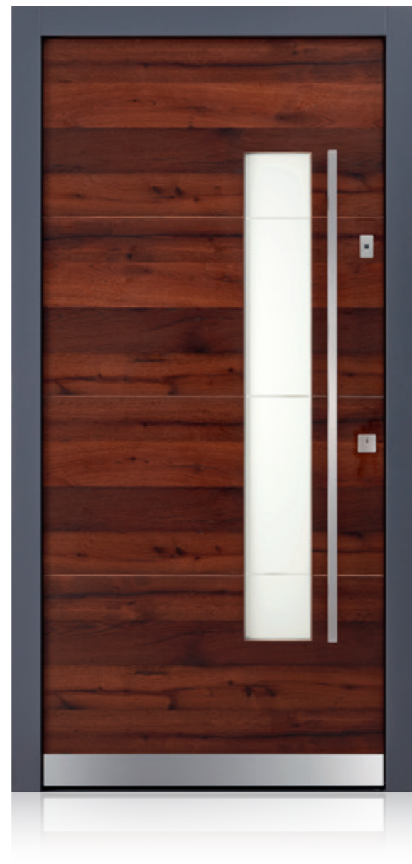
Modern 296 mit Vorsatzschale Alteiche lasiert 637E Stock RAL 7015 Schiefergrau Glasdesign 1003G, Fläche matt, Streifen klar Stoßgriff 1300E lichtausschnittlang Rosette 4200E Fingerscan mit Abdeckung Edelstahl Wetterschenkel 90 mm Edelstahl
