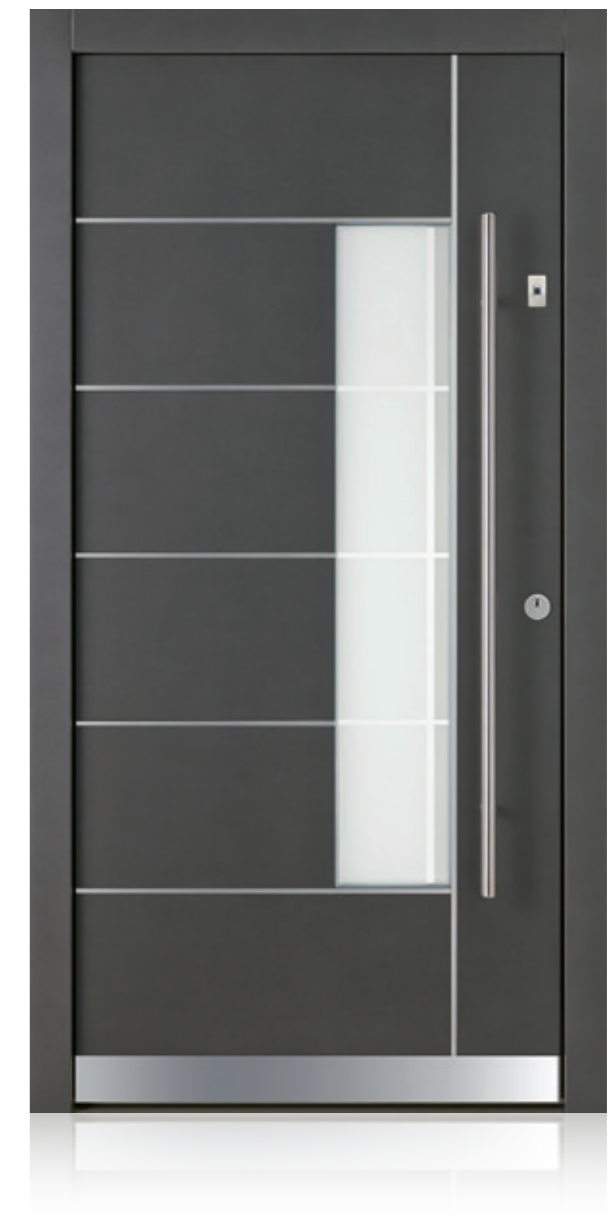
Modern 268 Trend 905 Edelstahllisenen 10 mm Glasdesign 1526G, Fläche matt, Streifen klar, Sandstrahlung Grau Stoßgriff 1100E lichtausschnittlang Rosette 4100E.b Fingerscan mit Abdeckung Edelstahl Wetterschenkel 90 mm Edelstahl
