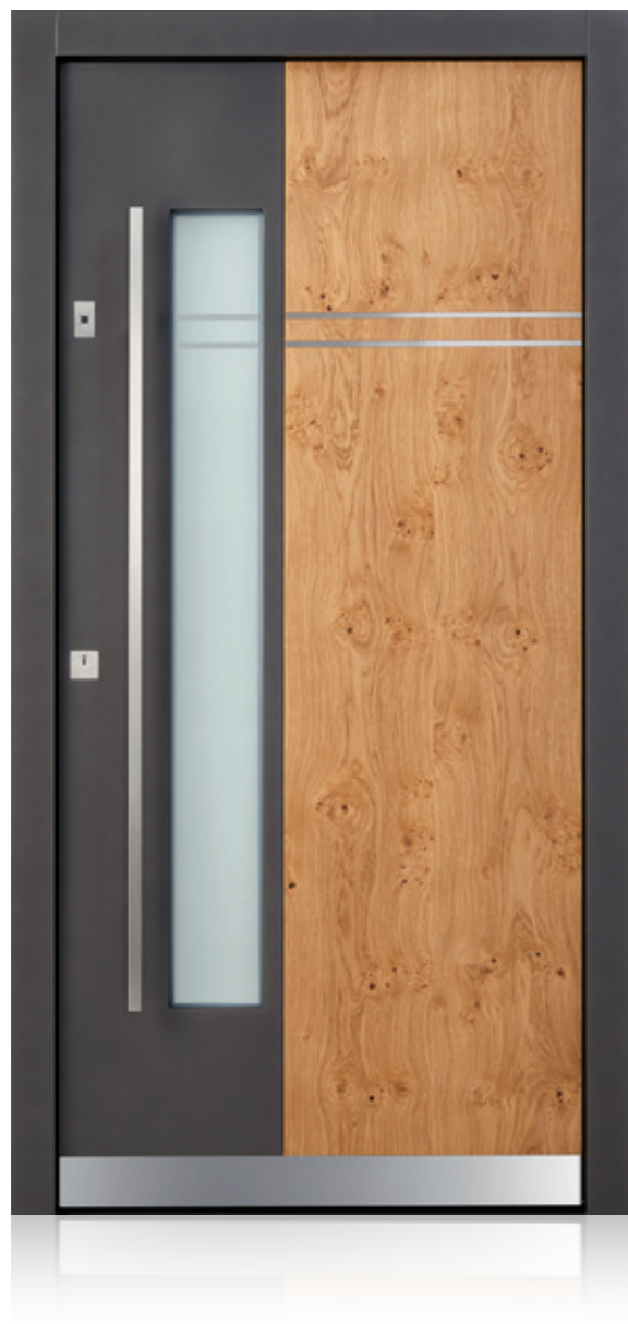
Modern 299 mit Vorsatzschale Trend 931 Bandfries Eiche astig lasiert 635E Edelstahlisenen 10 mm Glasdesign 1002G, Fläche matt, Streifen klar Stoßgriff 1300E lichtausschnittlang Rosette 4200E Fingerscan mit Abdeckung Edelstahl Wetterschenkel 90 mm Edelstahl
