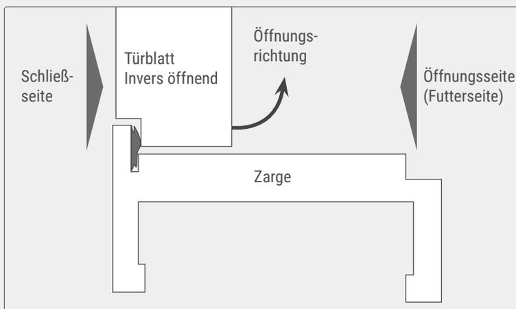
Die Ansicht der Türen ist von außen gleich – trotz verschiedener Öffnungsrichtungen. Im geschlossenen Zustand ist die Schließseite bündig. Die inverse Tür hat eine entgegengesetzte Öffnung - zur Futterseite des Elements.
