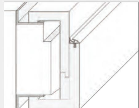
Die Blockzarge ermöglicht einen flächenbündigen Einbau der Zarge in die Wand. Ein Aluminiumwinkelprofil stellt den Übergang von Zarge zur Wand her.
